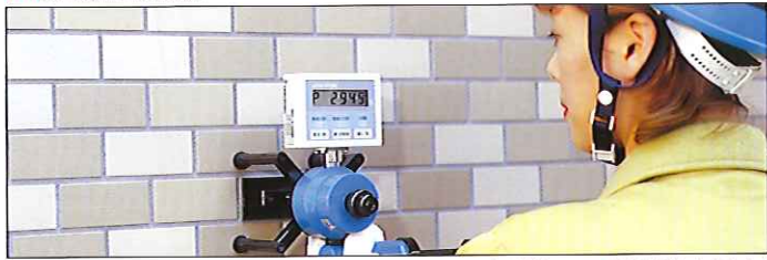
(外装タイル接着強度測定)
