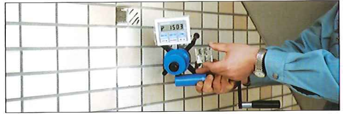
(外装タイル接着強度測定)
