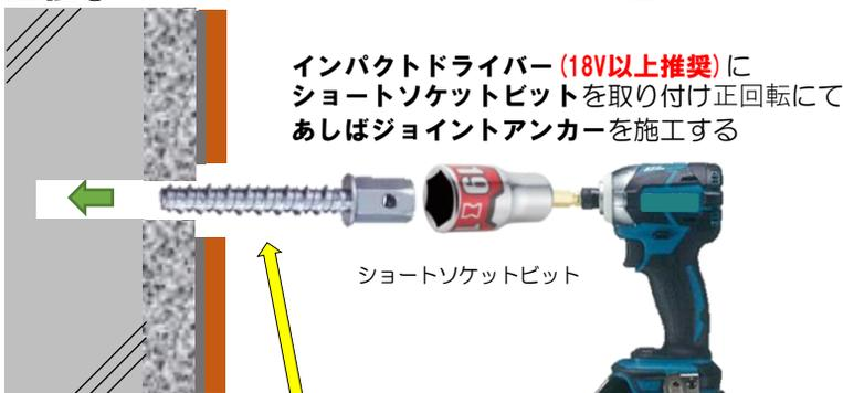
【注意】締め付け過ぎない。施工面から5ミリ程度浮かせて施工する。締め付け過ぎによるタイル破損に注意する。
